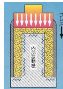
即脱工法での製法
