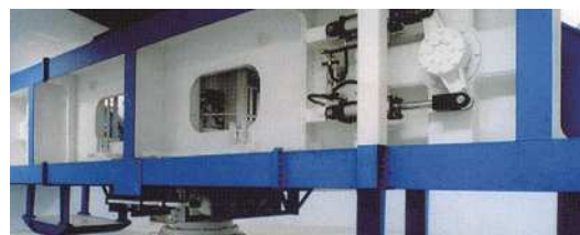
大型動的遠心力载荷試験装置（独立行政法人 土木研究所写真提供）
